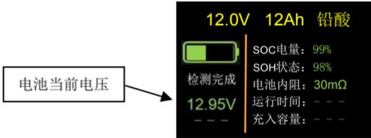
SOC电量百分数是依据当前电压与设备学习构建的SOC电压对照表查表计算得到。没有经过完整充放电学习的情况下，快速检测得到的SOC误差可能会比较大，仅供参考。SOH电池健康状态有“内阻对比”和“容量对比”两种评估算法。快速检测得到的SOH是采用内阻法，参照内建Ah-mΩ对照表来测定电池健康状态，给出1%~100%健康状态，此结论仅供参考。要得到准确的SOC和SOH，需要先运行一次【维护】功能才能测到准确数值。
