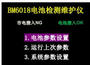
2. **连接市电**：**如果只是快速测量电池的参数（电压、内阻、SOD、SOH），可以不用接入市电，直接跳到下面第3步。**
