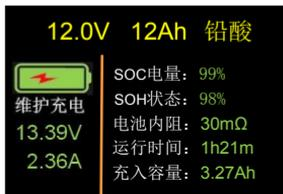
通常情况下，一个完整维护过程需要大约30个小时左右，维护过程完全结束后，得到电池的容量Ah值是最准确的。此时请按下《Up》键，显示屏就会显示出记录到完整的电池充放电曲线。
